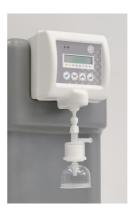
Раздача чистой воды осуществляется из водоразборного узла. Нажатием соответствующей кнопки можно выбрать один из трёх предлагаемых объёмов: 0,5 л, 1 л или 2 л. Пользователю не надо контролировать, пока наберётся необходимое количество воды. Система произведёт автоматический налив выбранного объёма и остановит свою работу. Если требуется наполнить накопитель большего объёма, установка выдаст очищенную воду без ограничения количества.
